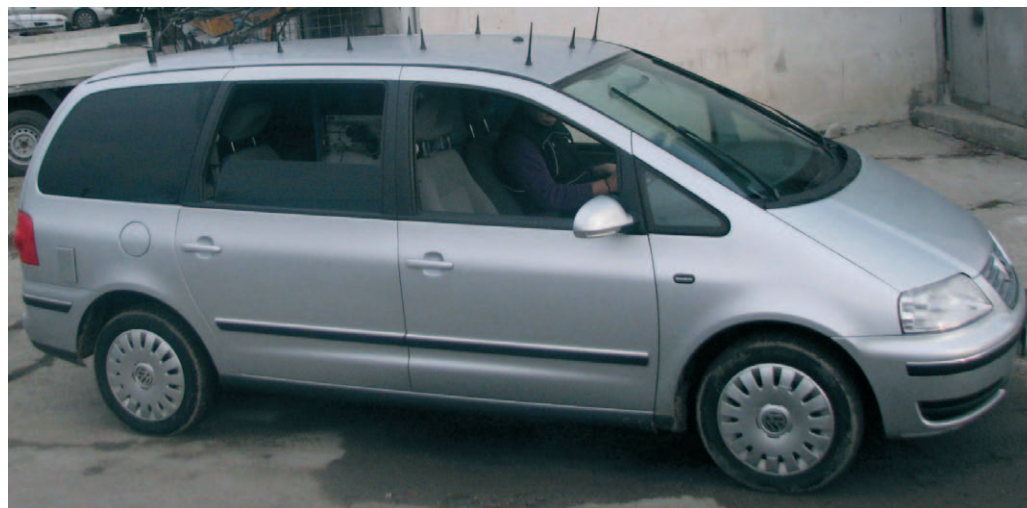
Fig. 5.11 Autospecială măsurători parametri de nivel și de calitate pentru verificarea în rețelele de comunicații mobile
