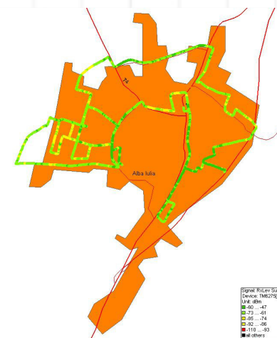
Fig 6.9 Traseu de măsură acoperire cu semnal 2G
