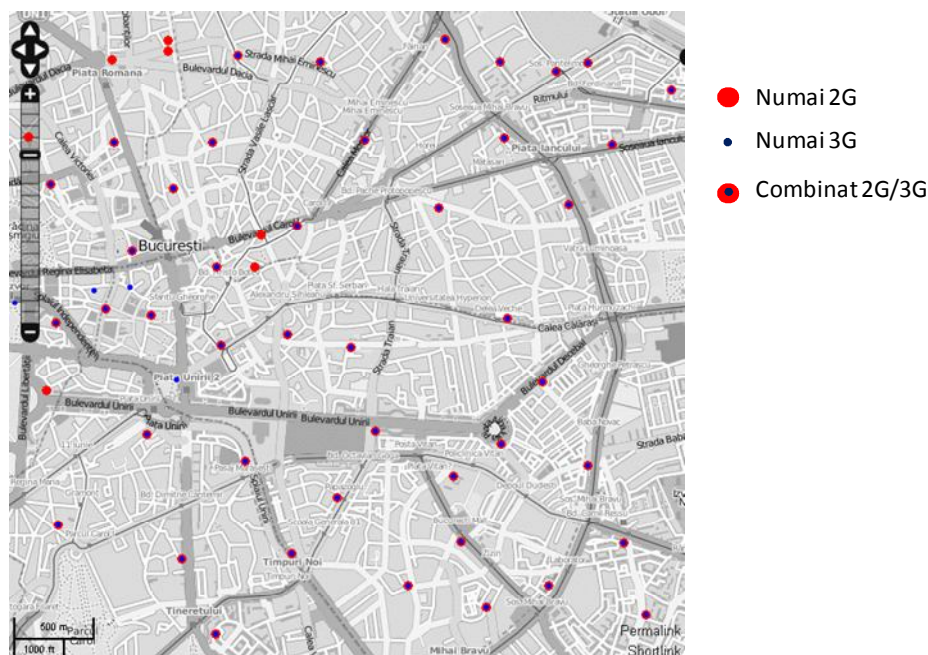
Figura 16: Statii de baza 2G si 3G in centrul Bucurestiului (numai de la un singur operator)
