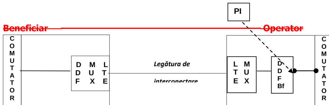
Figura 3—Interconectare directă în spațiul Operatorului (exemplu)
